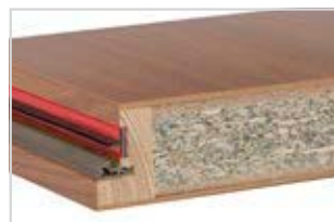
remplissage avec panneau spécial HALSPAN : 44 mm [EI30] / 54 mm [EI60]
